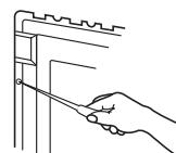
(注) 裏ブタを取り付ける時裏ブタ2ヶ所のフック(下側)を先にはめてから左、右を押し込んで4ヶ所ネジ止めして下さい。
