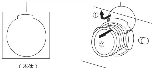
● 固定ホルダーの凸部と本体の凹部を合わせてから内部より押し込んで下さい。
