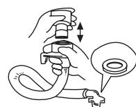
1 給水ホースのスプリングをホース側へ引き下け、水道栓の連結部とホースを離します。
