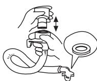
1 給水ホースのスプリングをホース側へ引き下げ、水道栓の連結部とホースを離します。
