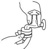
4 テープをはがして連結部の下の部分を右回しして充分にしめます。
