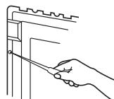
(注) 裏ブタを取付ける時裏ブタ2ヶ所のフック(下側)を先にはめてから左、右を押し込んで4ヶ所ネジ止めして下さい。
