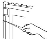
(注) 裏フタを取付ける時裏フタ2ヶ所のフック(下側)を先にはめてから左、右を押し込んで4ヶ所ネジ止めして下さい。
