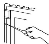
(注) 裏ブタを取付ける時裏ブタ2ヶ所のフック(下側)を先にはめてから左、右を押し込んで4ヶ所ネジ止めして下さい。
