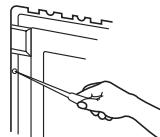
(注) 裏フタを取付ける時裏フタ2ヶ所のフック(下側)を先にはめてから左、右を押し込んで4ヶ所ネジ止めして下さい。
