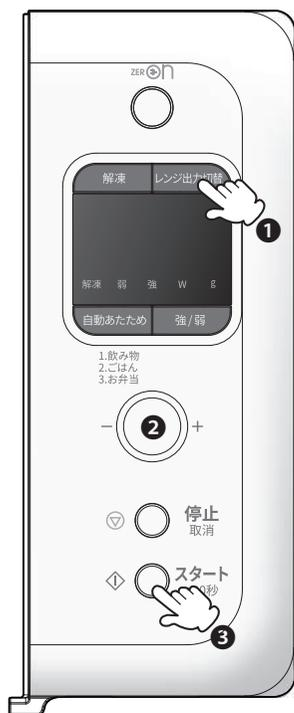
① レンジ出力切替ボタンを押して200Wに設定してください。
